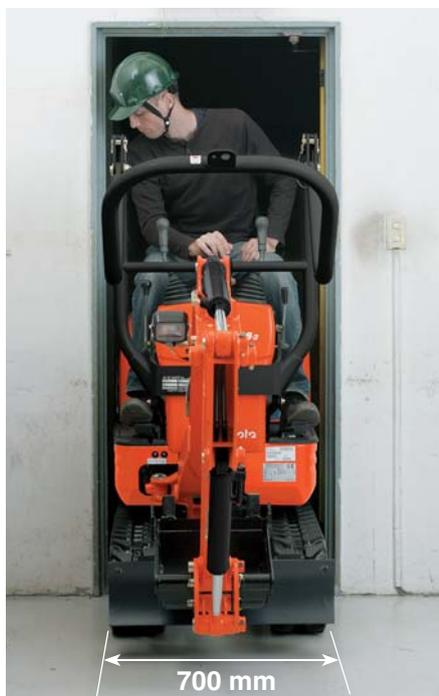
Lorsque la largeur du châssis est réduite à 700 mm, la K008-3 peut passer par la plupart des portes facilitant ainsi l'accès à l'intérieur des bâtiments.
