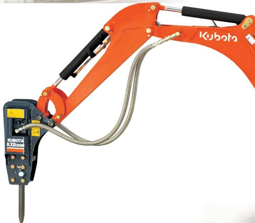
Flexibles hydrauliques du circuit auxiliaire
