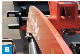
Vue sur les points d'ancrage du lève palette
